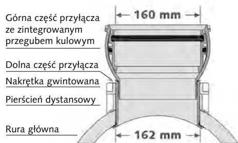
Przylącze siodłowe CONNEX DN/OD 160/162
