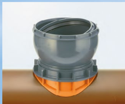
Przyłącze siodłowe CONNEX DN/OD 160/162 zamontowane na rurze kanalizacyjnej HS®, otwór 162 \pm 1 mm
