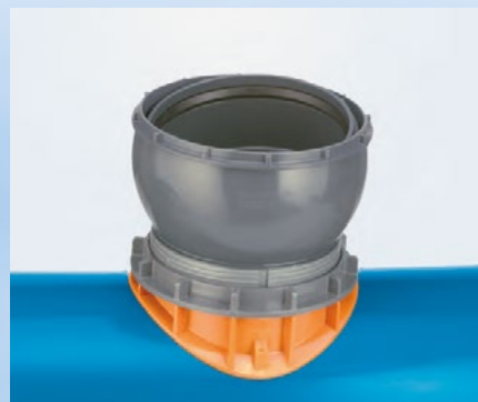
Przyłącze siodłowe CONNEX DN/OD 200/200 zamontowane na rurze kanalizacyjnej HS®, otwór 200 \pm 1 mm
