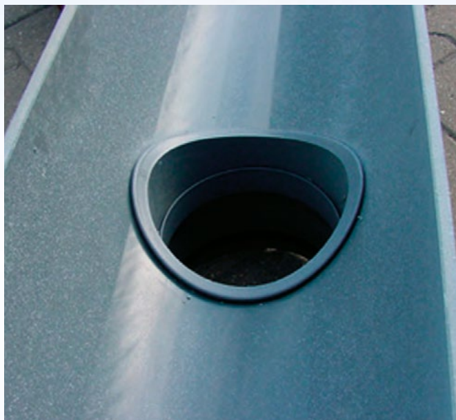
Widok od wewnątrz po „hamburskiej” próbie płukania
