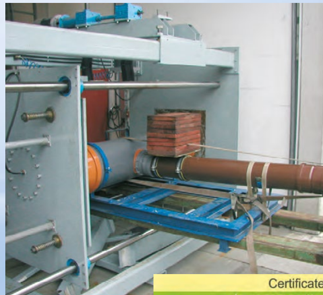
Stanowisko do przeprowadzenia próby na siły ścinające
